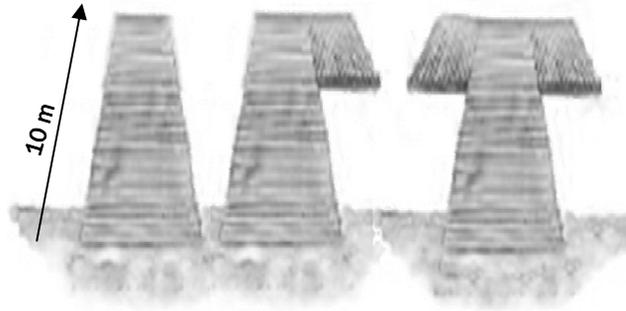
Toutefois, *si la profondeur d'eau à l'extrémité du quai est inférieure à 1 m (3 pi)*, le quai peut être rallongé jusqu'à l'obtention d'une profondeur d'eau de 1 m, sans dépasser une longueur de **15 m** (50 pi), à condition qu'il n'occupe pas plus de **10 %** de la largeur du plan d'eau (distance d'une rive à l'autre) et qu'il n'entrave pas la navigation.
